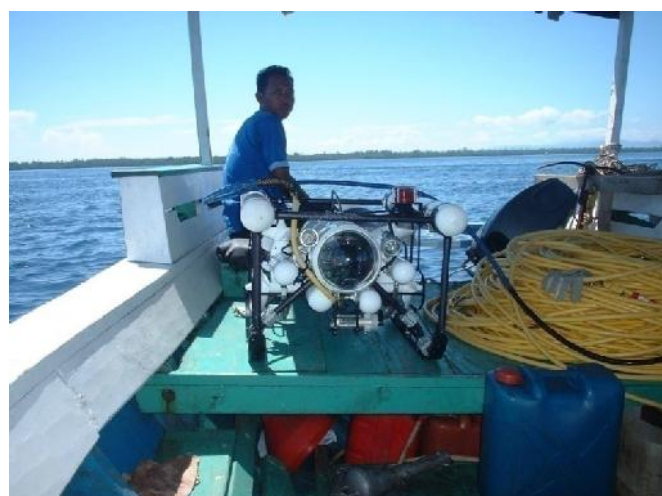
Gambar 5. ROV ( Remotely Operated Vehicle ) robot bawah air dari Aquamarine Fukusihima (Jepang), untuk merekam kehidupan ikan coelacanth di gua-gua bawah laut. (Foto: Dok. Kasim Moosa)
